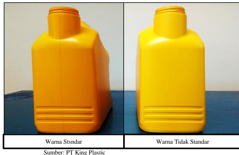
Gambar 3.18 Warna tidak standar
